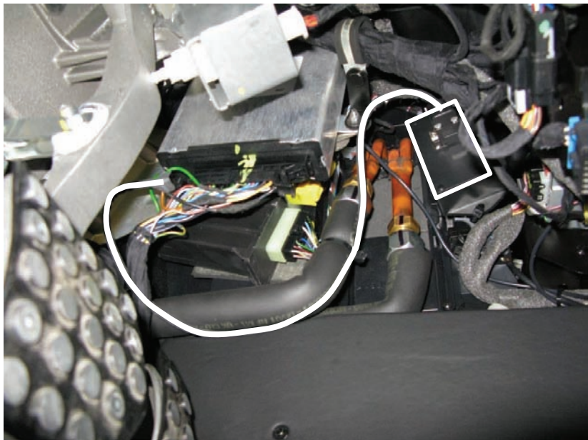
Mitgeliefertes Fahrwerkssteuergerät mit Kabelbinder befestigen und nach Schaltplan 1 an das Original Fahrwerkssteuergerät anschließen.
