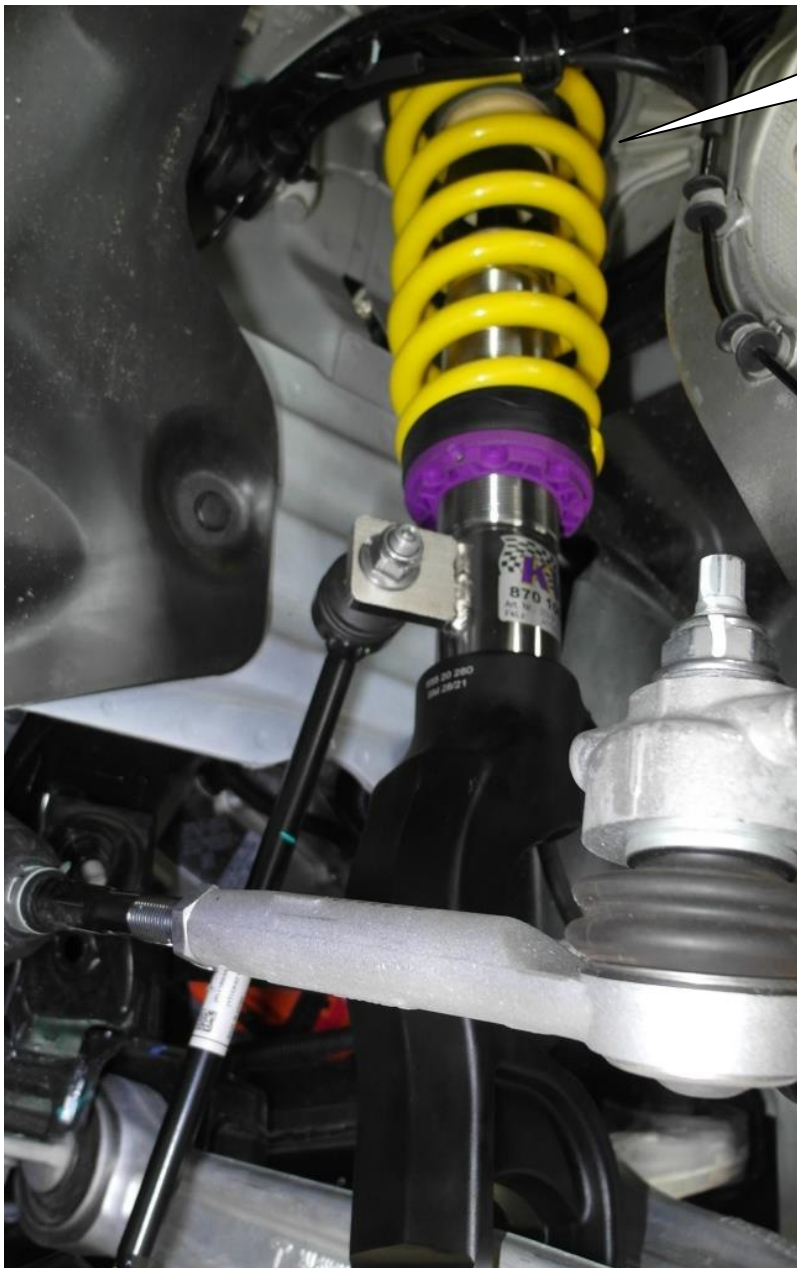
Montiertes Federbein. Installed coilover strut.
