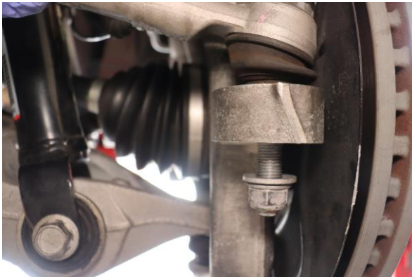
Step 6. Loosen the tie rod end nut.
